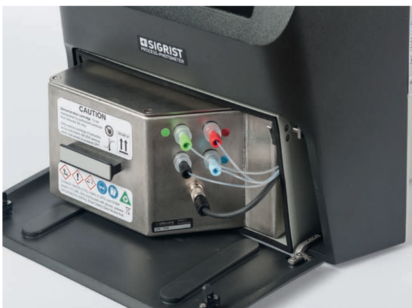
Rezyklierbare Kartusche für Reagenzien, Reinigungsmitteln und Abfall.
