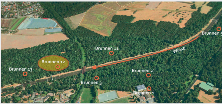
Fig. 3 Im flussnahen Brunnen 12 wurde eine Messstation eingerichtet, um Qualitätsveränderungen im Grundwasser durch Infiltration von Wiesewasser zu verfolgen.
