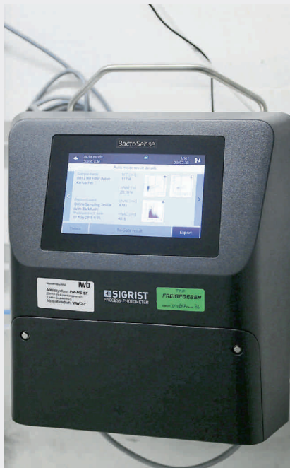
Fig. 7 Online-Durchflusszytometer BactoSense (Sigrist Photometer) zur Messung der Totalzellzahl
