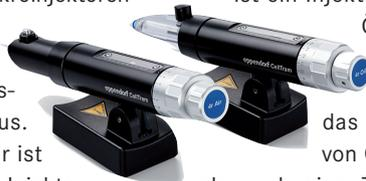
Stammzellen). Der CellTram 4 Oil ist ein Injektor mit einem Ölbefüllungssystem, das sowohl das Verschütten von Öl verhindert als auch eine Zeitersparnis während des Füllvorgangs gewährleistet. In Kombination mit einem Kapillarenhalter, der eine Injektion im Winkel <math>< 15^\circ</math> ermöglicht, wird eine mechanische Be-
