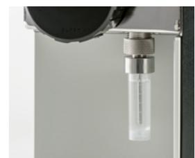
Dispositif d'échantillonnage manuel
